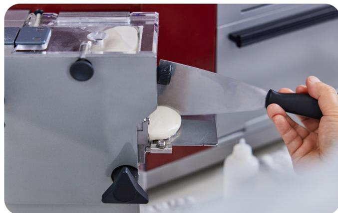
Le **FARINOGRAPHE** génère une courbe indiquant la puissance nécessaire pour former la pâte dans le temps pendant que la farine et l'eau se mélangent. Les résultats décrivent les propriétés de pétrissage de la pâte et comprennent ce qui suit:
