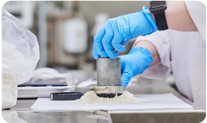
Le **GLUTEN HUMIDE** est une mesure de la quantité de gluten contenue dans des échantillons de blé moulu (mouture entière) ou de farine, déterminée à l'aide du système Glutomatic. Le gluten humide se forme lorsqu'on ajoute de l'eau salée 2% aux protéines contenues dans le blé ou la farine moulu; il est à l'origine des caractéristiques d'élasticité et d'extensibilité de la pâte.
